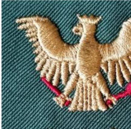
Um aus der **Vektordatei** eine schöne Stickerei herzustellen, bedarf es noch einiges an **Aufwand**. Der Adler, der in der Vektordatei aus einer Fläche besteht, wird in einzelne Bereiche unterteilt. So werden das Gefieder, die Krone, der Schnabel, die Adlerfänge und Klauen herausgearbeitet. Die Stickerei hat eine Größe von **ca. 3 x 3 cm**. Klicken Sie jeweils auf das einzelne Bild um es zu vergrößern.
